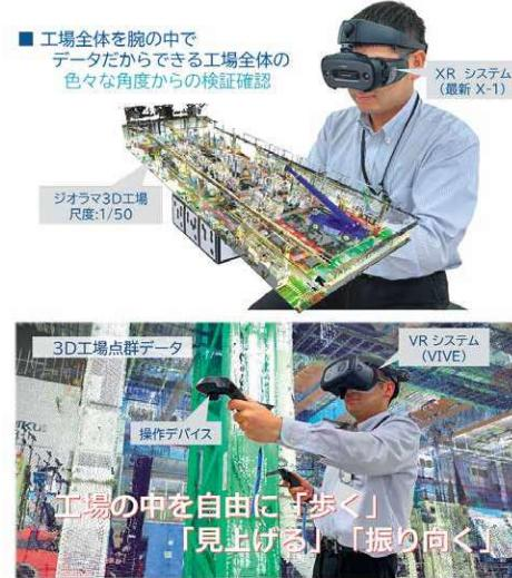
XRシステムは、工場全体を実寸サイズで自由に歩き回りながら、設備計画の検証や作業性・スペースの確認を可能にし、安全かつやり直しのない設備導入を実現します。
