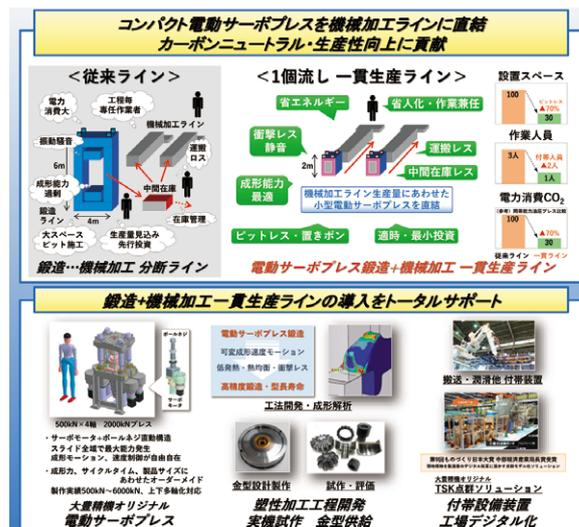
コンパクト電動サーボプレスによる冷間鍛造工法と機械加工を組み合わせることで、一貫生産ラインを構築し、中間在庫の削減と省人化を実現しました。これにより、CO<sub>2</sub>排出量の削減に貢献する環境に配慮した設備となっています。
